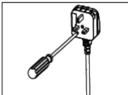
Закройте крышку адаптера и закрепите ее, затянув невыпадающий винт машины между двумя горизонтальными штекерными контактами.
