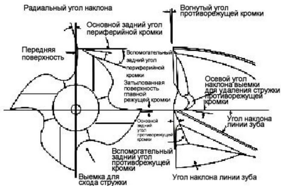
Схема (5) Наименование каждой части концевой фрезы и ее геометрическое очертание
