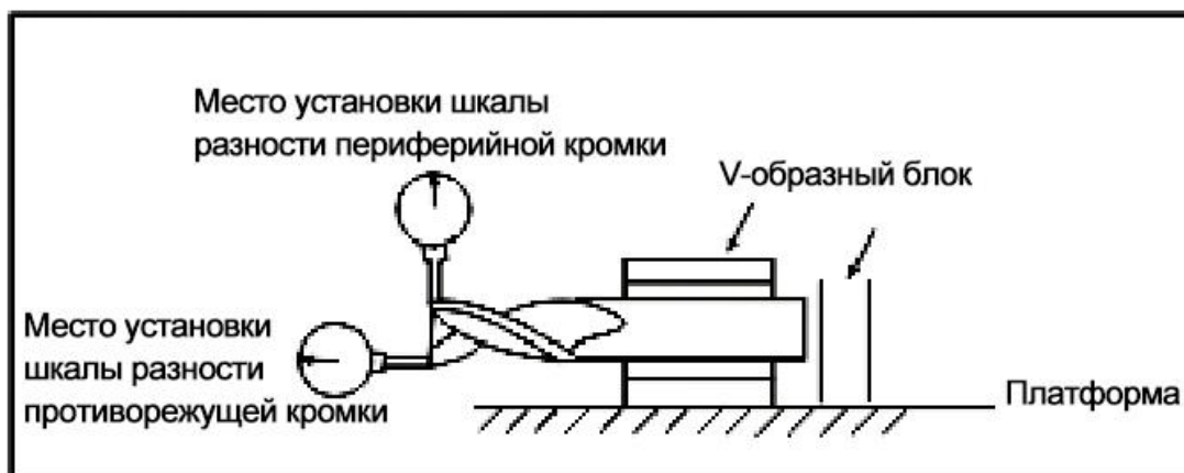
Схема (46) Установка шкалы для замера разности периферийной кромки и противорежущей кромки
