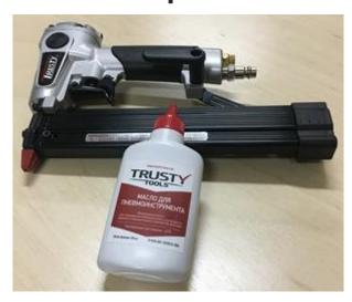
Внутри пневматического инструмента есть уплотнительные кольца и прокладки, выполненные из резины. Эти кольца обеспечивают герметичность клапанов и движимых элементов и нуждаются в смазке.
